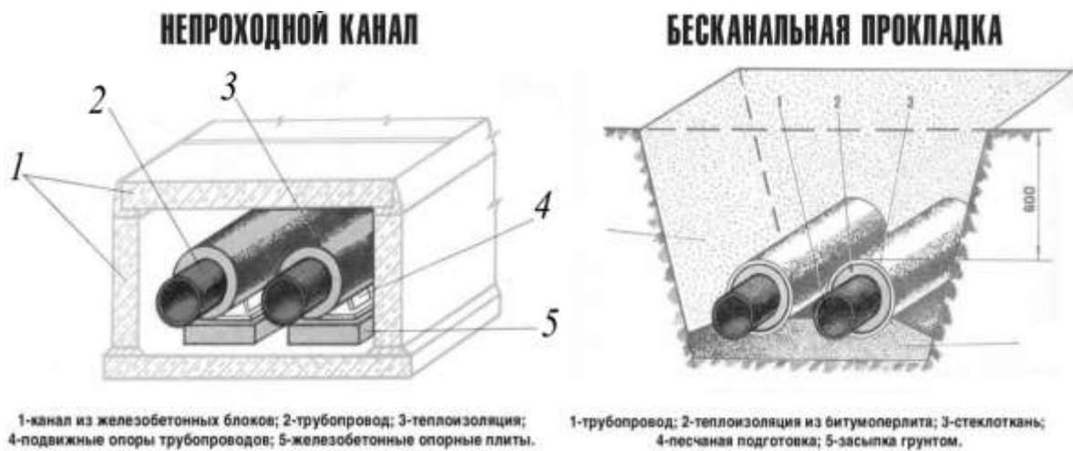
Рис. 35. Канальная и бесканальная прокладка тепловой сети
